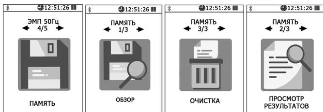
Функция обзора памяти измерителя отображает на экране сведения о количестве обследованных контролируемых зон, суммарном количестве сделанных замеров и объеме свободного места.
