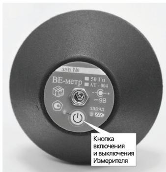
не будет осуществляться связь с устройством отображения результатов измерений, Измеритель автоматически выключится.
