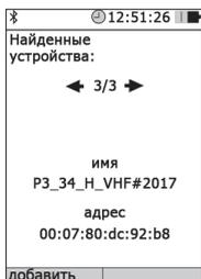
По окончании поиска на экране блока НТМ-Терминал появится сообщение «поиск завершен!» и указано количество найденных bluetooth-устройств. Среди них могут быть не только анетнны-преобразователи и датчики, а, например, мобильные устройства.
